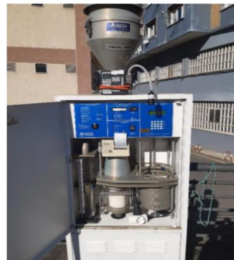
12. irudia: Partikulak atzemateko Digitel High Volume ekipamendua, iragazkiekin eta puff-arekin. Eskuinaldean, poliuretanozko puff-a, kutsatzailea atzemateko.
