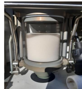
12. irudia: Partikulak atzemateko Digitel High Volume ekipamendua, iragazkiekin eta puff-arekin. Eskuinaldean, poliuretanozko puff-a, kutsatzailea atzemateko.
